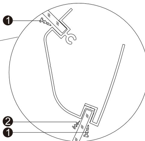
Recommandation : afin d'installer les joints avec plus de facilité, vous pouvez les imprégner d'eau savonneuse, et desserrer les vis 4x35 (sans oublier de les reserrer une fois les joints en place)
